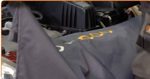
3 Puhastage amordipüstaku ülemised kinnitused. Kasutage terasharja. Kasutage WD-40 aerosooli.
