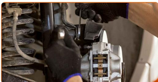
**15** Paigaldage kinnitus, mis ühendab põikstabilisaatorit õõtshoovaga ja pingutage seda. Kasutage kombivõtit Nr.13. Kasutage padrunit Nr.13. Kasutage padrunit Nr.17. Kasutage momentvõtit. Pingutage seda 20 Nm pöördemomendiga.
