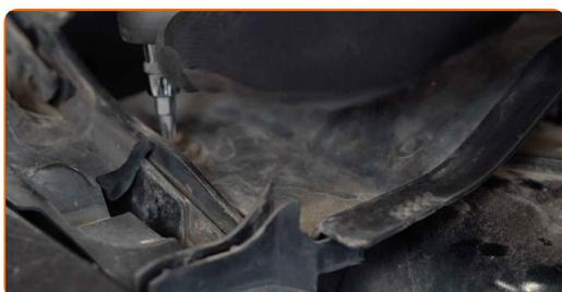
10 Eemaldage alumine plastikust tuuleklaasi õhutusvõre.
