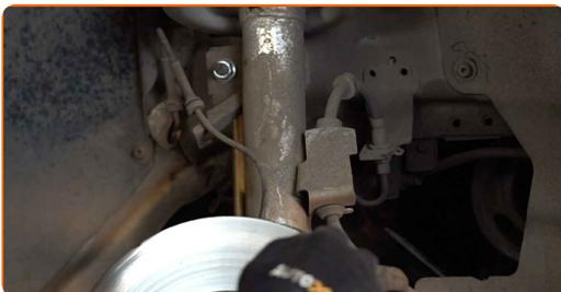
18 Puhastage kinnitused, mis ühendavad stabilisaatorilinke vedrupüstakutega ja need, mis ühendavad vedrupüstakuid käändteljega. Kasutage terasharja. Kasutage WD-40 aerosooli.
