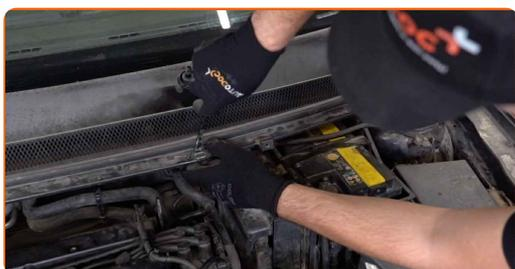
8 Tõstke üles plastikust klaasipuhasti võre.
