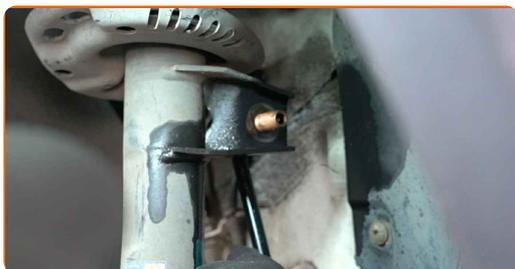
**12** Pingutage kinnitust, mis ühendab stabilisaatorilülid amordipüstakuga. Kasutage kombivõtit Nr. 15. Kasutage padrunit Nr.19. Kasutage momentvõtit. Pingutage seda 60 Nm pöördemomendiga.
