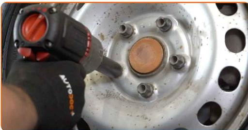
**25** Laske auto alla ja töödake risti järjekorras, pingutage rataste poldid. Kasutage ratta löökpadrunit #17. Kasutage momentvõtit. Pingutage seda 120 Nm pöördemomendiga.
