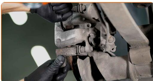
**8** Ühendage ABS sensor elektripistikust lahti. Ühendage kulunud piduriklotside anduri pistikud lahti. Eemaldage ABS-anduri ühendus. Eemaldage piduriklotsi kulumisanduri ühendus.
