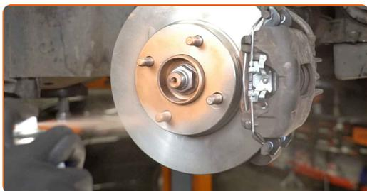
**38** Puhastage piduriketaste pind. Kasutage piduri puhastusvahendit.
