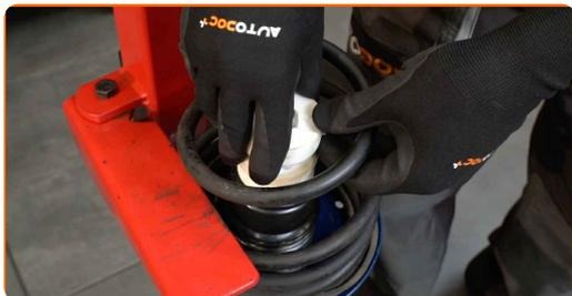
**32** Paigaldage ülemine vedrupüstak ja vedrupüstaku laager.
