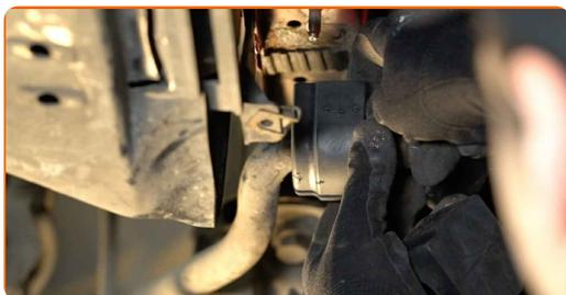
13 Puhastage stabilisaatori pukside paigalduskohad. Kasutage WD-40 aerosooli.
