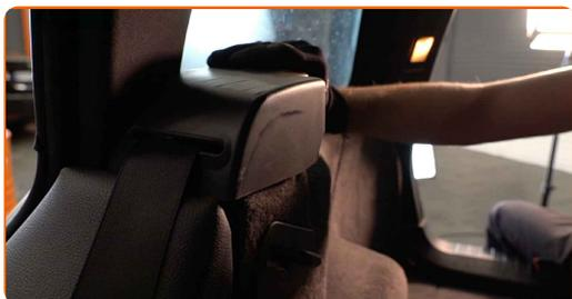
5 Eemaldage pagasiruumi külgmise voodri plastmassist fiksaator. Kasutage sõrgkangi.
