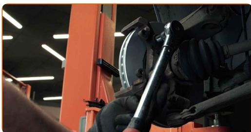
**24** Paigaldage piduriklotsid.
