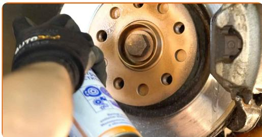
**97** Puhastage piduriketta pind. Kasutage piduri puhastusvahendit.
