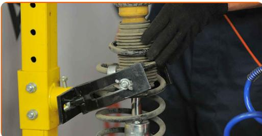
**54** Paigaldage ülemine vedrupüstak ja vedrupüstaku laager. Kasutage tühikut Nr.H5.
