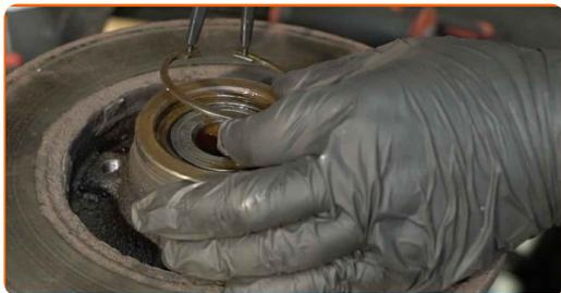
**23** Suruge rattarummu laager välja. Kasutage pukside ja laagrite vahetamiskomplekt.
