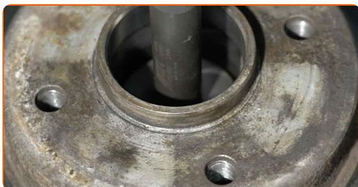
**24** Puhastage rummu laagri kinnituspesa. Kasutage WD-40 aerosooli.
