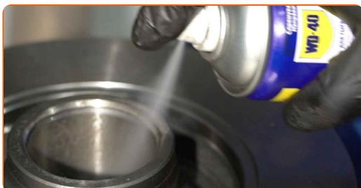
**25** Paigaldage uus rummulaager, surudes see pidurikettale. Kasutage pukside ja laagrite vahetamiskomplekt.
