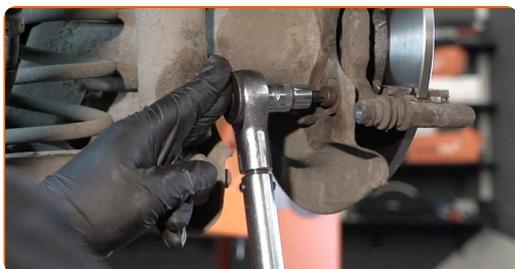
**36** Paigaldage piduriklotsid.
