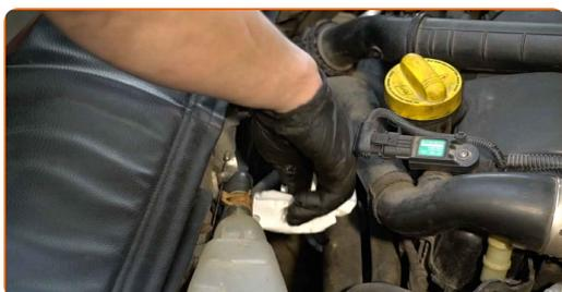
**15** Paigaldage uus õlifilter.
