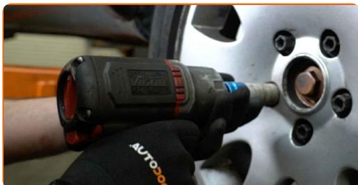
**46** Laske auto alla ja töödake risti järjekorras, pingutage rataste poldid. Kasutage ratta löökpadrunit #17. Kasutage momentvõtit. Pingutage seda 120 Nm pöördemomendiga.
