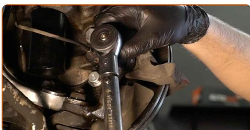
**30** Paigaldage piduriklotsid.
