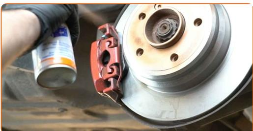
**31** Puhastage piduriketta pind. Kasutage piduri puhastusvahendit.
