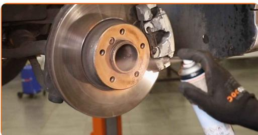
**20** Puhastage piduriketta pind. Kasutage piduri puhastusvahendit.
