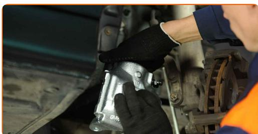
22 Paigaldage piduriklotsid.
