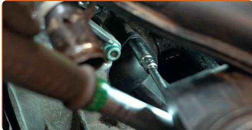
**36** Pingutage generaatori elektrikaabli kinnitit. Kasutage padrunit Nr.13. Kasutage momentvõtit. Pingutage seda 5 Nm pöördemomendiga.
