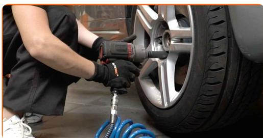
**29** Laske auto alla ja töödake risti järjekorras, pingutage rataste poldid. Kasutage ratta löökpadrunit #17. Kasutage momentvõtit. Pingutage seda 120 Nm pöördemomendiga.
