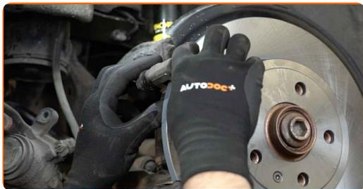
22 Paigaldage piduriklotsid.
