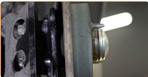
**14** Puhastage piduriketta pind. Kasutage terasharja. Kasutage WD-40 aerosooli.
