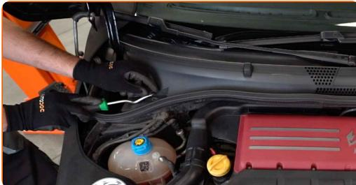
**4** Tõstke üles plastikust klaasipuhasti võre.
