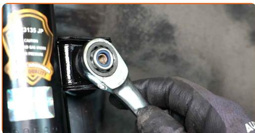
**13** Pingutage kinnitust, mis ühendab stabilisaatorilülid amordipüstakuga. Kasutage padrunit Nr.17. Kasutage momentvõtit. Pingutage seda 55 Nm pöördemomendiga.
