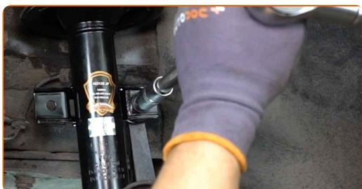
**14** Pingutage kinnitust, mis ühendab stabilisaatorilüli stabilisaatorvarbiga. Kasutage padrunit Nr.17. Kasutage momentvõtit. Pingutage seda 55 Nm pöördemomendiga.
