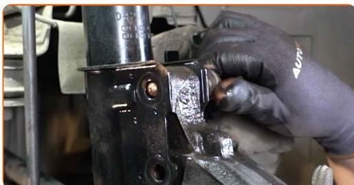
**36** Pingutage alumisi amordipüstaku ja käändtelje vahelisi kinnitusi. Kasutage kombivõtit Nr. 18. Kasutage padrunit Nr.18. Kasutage momentvõtit. Pingutage seda 120 Nm pöördemomendiga.
