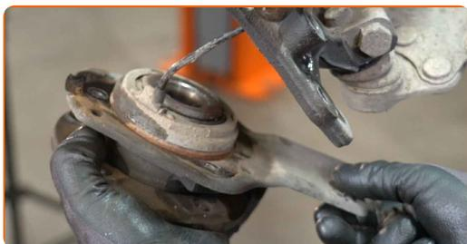
**23** Puhastage rummu laagri kinnituspesa. Kasutage terasharja. Kasutage WD-40 aerosooli.
