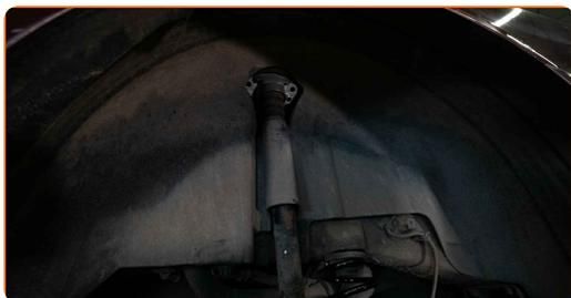
20 Paigaldage amortisaatori vedrupüstak juhindudes paigaldamisel keskmisest august.
