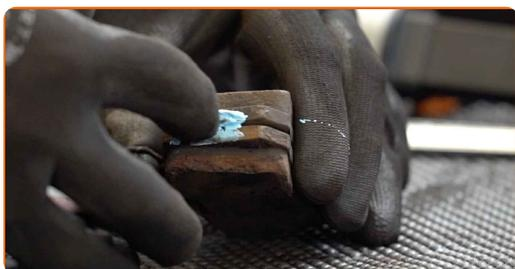
**24** Paigaldage piduriklotsid.
