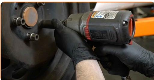
42 Laske auto alla ja töödake risti järjekorras, pingutage rataste poldid. Kasutage ratta löökpadrunit #17. Kasutage momentvõtit. Pingutage seda 120 Nm pöördemomendiga.
