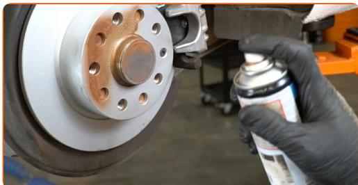
**39** Puhastage piduriketta pind. Kasutage piduri puhastusvahendit.
