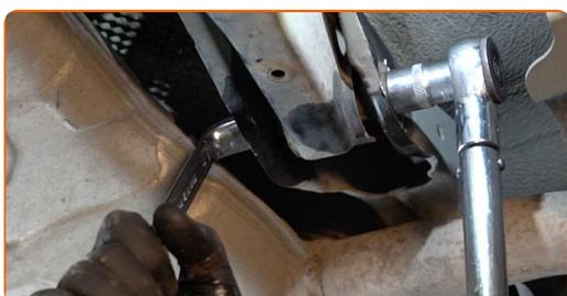
**26** Pingutage kinnitust, mis ühendab õõtsu tagumise käändteljega. Kasutage kombivõtit Nr. 18. Kasutage padrunit Nr.18. Kasutage momentvõtit. Pingutage seda 90 Nm pöördemomendiga.+90°
