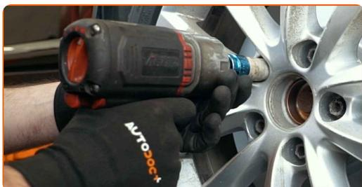
21 Laske auto alla ja töödake risti järjekorras, pingutage rataste poldid. Kasutage ratta löökpadrunit #17. Kasutage momentvõtit. Pingutage seda 120 Nm pöördemomendiga.
