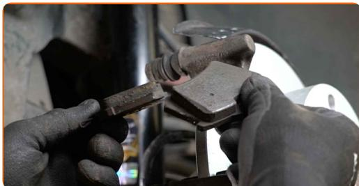
**16** Paigaldage piduriklotsid.
