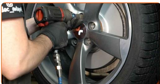
**34** Laske auto alla ja töödake risti järjekorras, pingutage rataste poldid. Kasutage ratta löökpadrunit #17. Kasutage momentvõtit. Pingutage seda 120 Nm pöördemomendiga.
