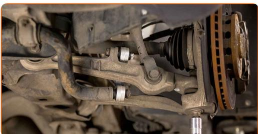
**16** Pingutage kinnitust, mis ühendab stabilisaatorilüli stabilisaatorvarbiga. Kasutage kombivõtit Nr. 16. Kasutage momentvõtit. Pingutage seda 40 Nm pöördemomendiga.+90°
