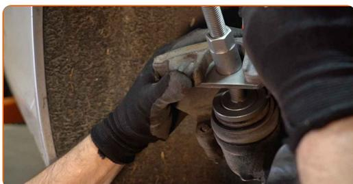
26 Paigaldage piduriklotsid.
