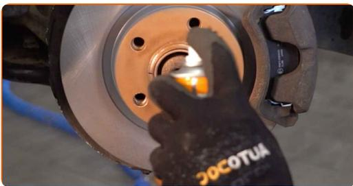
19 Puhastage piduriketta pind. Kasutage piduri puhastusvahendit.
