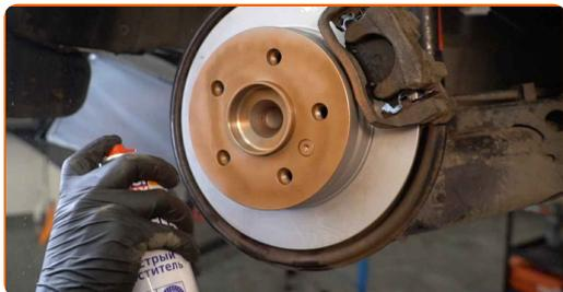
**29** Puhastage piduriketta pind. Kasutage piduri puhastusvahendit.
