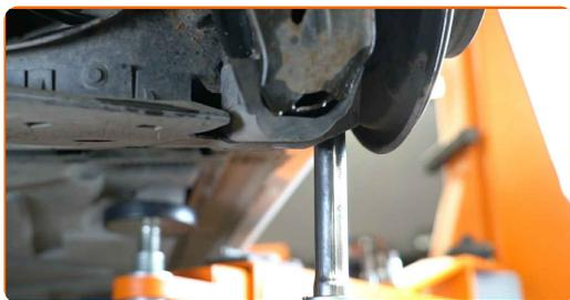
**29** Pingutage kinnitust, mis ühendab õõtsharki tagumise käändteljega. Kasutage kombivõtit Nr. 18. Kasutage padrunit Nr.18. Kasutage momentvõtit. Pingutage seda 85 Nm pöördemomendiga.
