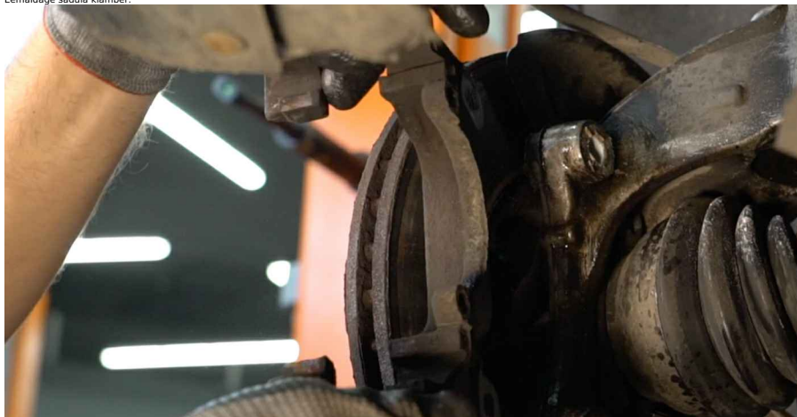
16 Puhastage pidurikettaga kinnitused. Kasutage terasharja. Kasutage WD-40 aerosooli.
