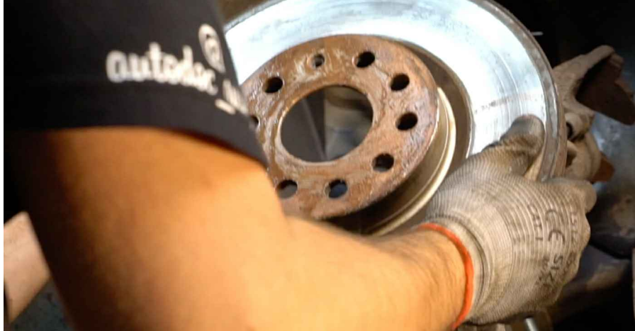
19 Puhastage rumm. Kasutage terasharja. Määrige kontaktpinnad. Kasutage vasemääret.
