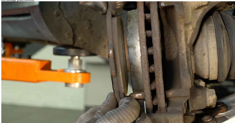
13 Puhastage pidurisadula kinnitused. Kasutage terasharja. Kasutage WD-40 aerosooli.
