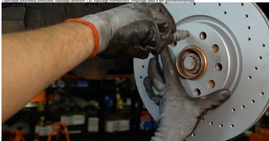
21 Tugevdage piduriketta kinnitused. Kasutage tähkvõtit T30. Kasutage momentvõtit. Pingutage seda 4 Nm pöördemomendiga.
