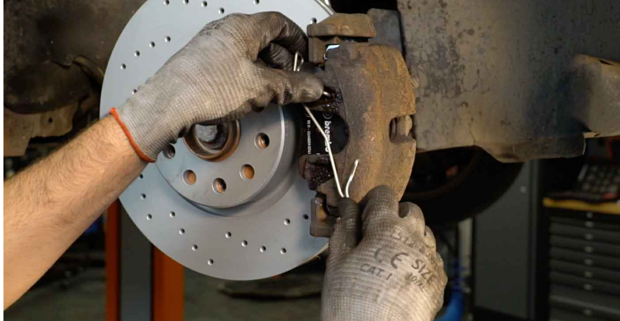
31 Määrige pinda, kus piduriketras puutub kokku veljega. Kasutage vasemääret.
