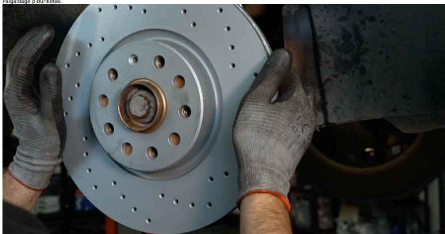
21 Tugevdage piduriketta kinnitused. Kasutage tähkvõtit T30. Kasutage momentvõtit. Pingutage seda 4 Nm pöördemomendiga.
