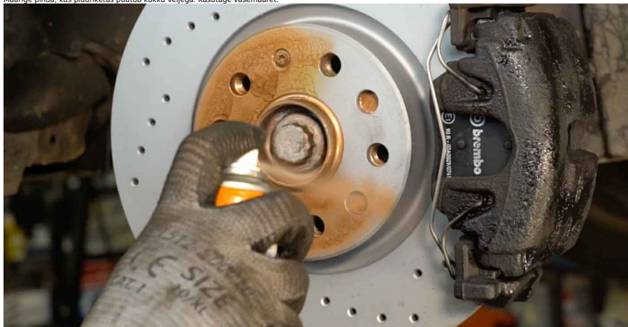
32 Puhastage piduriketras pind. Kasutage piduri puhastusvahendit.
