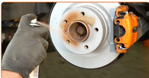
**38** Puhastage piduriketaste pind. Kasutage piduri puhastusvahendit.
