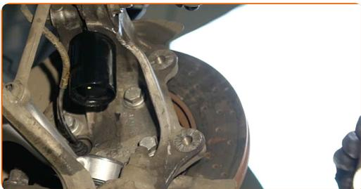
**19** Puhastage piduriketta kinnitused. Kasutage terasharja. Kasutage WD-40 aerosooli.
