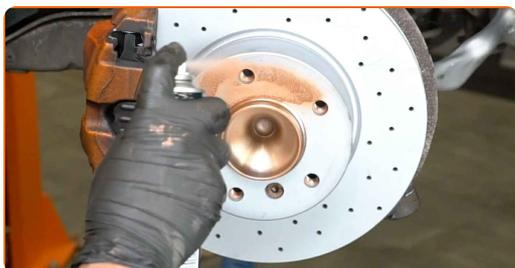
**36** Puhastage piduriketaste pind. Kasutage piduri puhastusvahendit.
