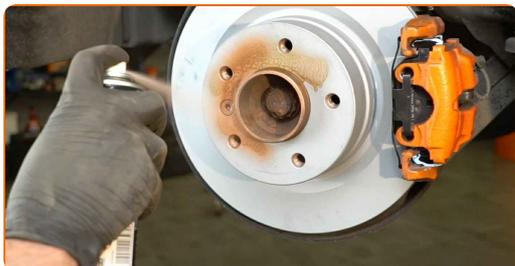
**38** Puhastage piduriketast pind. Kasutage piduri puhastusvahendit.
