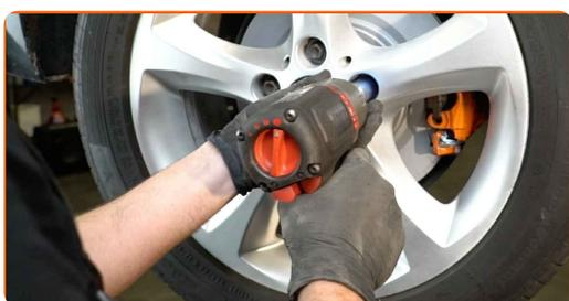
**41** Laske auto alla ja töödake risti järjekorras, pingutage rataste poldid. Kasutage ratta löökpadrunit #17. Kasutage momentvõtit. Pingutage seda 120 Nm pöördemomendiga.
