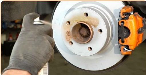
**32** Puhastage piduriketta pind. Kasutage piduri puhastusvahendit.
