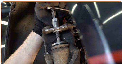
**31** Paigaldage piduriklotsid.
