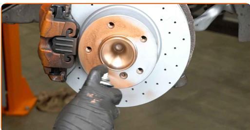
**15** Puhastage piduriketta pind. Kasutage piduri puhastusvahendit.
