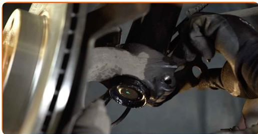
41 Paigaldage ja pingutage uut käändtelje polti.
