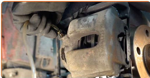
21 Vajutage piduripedaali mitu korda, et eemaldada süsteemist õhk.
