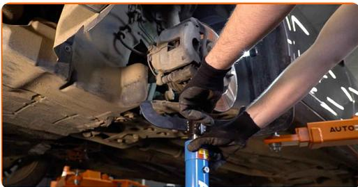
**15** Keerake lahti alumine kinnitus, mis ühendab amordipüstakut käändteljega. Kasutage kombivõtit Nr. 15. Kasutage padrunit Nr.17. Kasutage toruvõtit.
