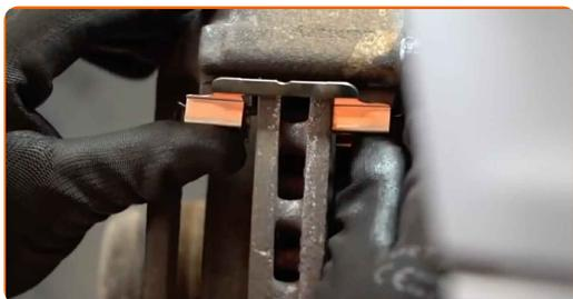
28 Paigaldage piduriklotsid.
