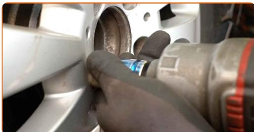
**53** Laske auto alla ja töödake risti järjekorras, pingutage rataste poldid. Kasutage ratta löökpadrunit #17. Kasutage momentvõtit. Pingutage seda 130 Nm pöördemomendiga.
